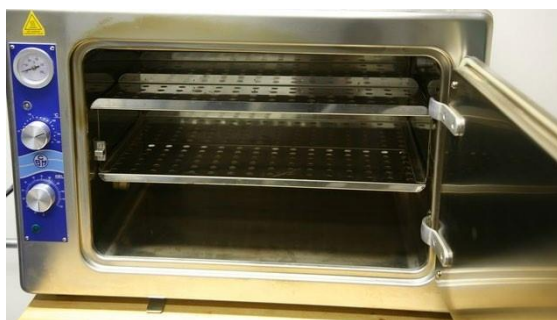
شکل: فور یا اون یا حرارت خشک یا oven (نوع رومیزی یا قابل حمل). اندازه دستگاه بر مبنای لیتر، حجم مفید داخلی آن است.
