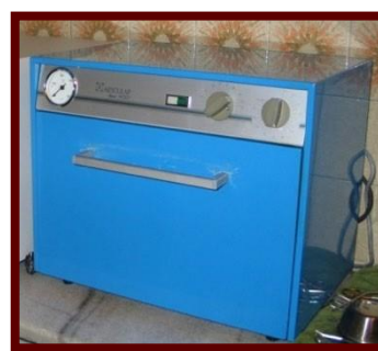
شکل: فور یا اون یا حرارت خشک یا oven (نوع رومیزی یا قابل حمل). اندازه دستگاه بر مبنای لیتر، حجم مفید داخلی آن است.
