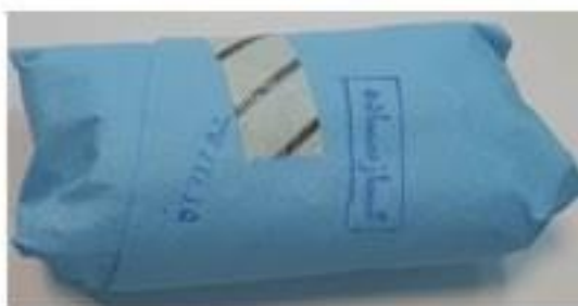
شکل : انواع بسته بندی وسایل قبل از قرار دادن در اتوکلاو. معمولاً تاریخ استریلیزاسیون روی نشانگر نوشته می شود.
